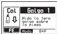
Figura 2.6: Inicio de la calibración de galga-1
