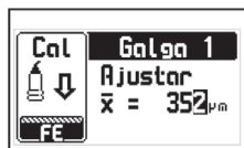
Figura 2.8: Pantalla de ajuste del espesor de la galga
